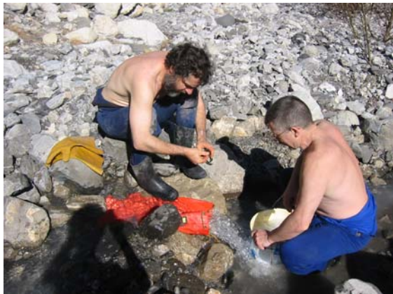
Fig. 60 : jaugeage au seau de la source sulfureuse (Photo Guillaume Isnard)
